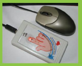
Бытовой пульсограф (фотоплетизмограф) **Pulse Light** с датчиком на отражение (в корпусе) и на просвет (прищепка на палец). ПО для записи, сохранения, печати и анализа плетизмограмм в комплекте.
