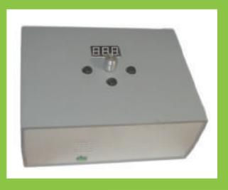
Частотный преобразователь **MotorMaster** 2,2 кВт, 220В (одна фаза) включение обмоток - треугольник; RS485, вход ПИД и линейного регулятора.
