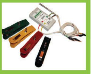
Бытовой USB кардиограф **ECG Light** на 6 отведений от конечностей (I, II, III, avR, avL, avF), ПО для записи, сохранения, печати и анализа кардиограмм в комплекте.
